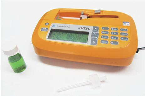
微量差圧式粘度計「マイクロビスクエス」は、約 100 $\mu$ l の試料で実測が行える微量粘度計です。小型サイズで持ち運びにも便利です。
