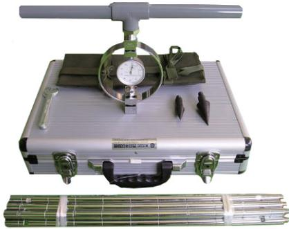
先端コーンを人力によって静的に土中へ押し込む時に要する貫入抵抗をプルーピングリングで測定し、粘性土の相対的強度・粘着力・一軸圧縮強度及び許容地耐力の概算値等を求めます。軟弱な粘土、シルトあるいは泥炭を主体とする軟弱地盤が最適で、粘性土のおよその粘着力、深さを迅速に測定し、地盤断面の概略を把握するのに便利です。
