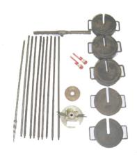
試験結果もデータシートがあり試験表と図示により 土の状態がはっきり表示できる特徴があります。土 の現位置調査上益々利用される傾向があります。 S-215 は、スクリューポイント付きのロッドに計 100kg の重錘で荷重をかけ、貫入量当たりの回転数 (半回転)を求めます。標準貫入試験との相関性が 良いとされています。
