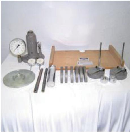
油圧ジャッキは容量 5ton のもので最小目盛 100kg のブルドン管式圧力計を使用しています。
