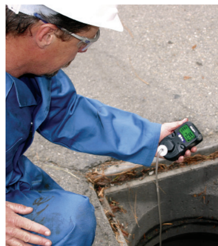
オプションのサンプリングフロートを使用した閉鎖空間侵入前の測定
