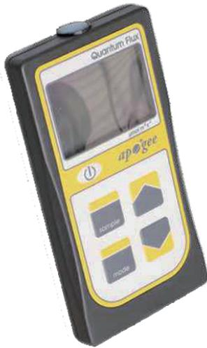
光合成は 400 ～ 700nm 光子数によって大きく左右されます。この光を光合成光子粒 (ppF) といひ、本器はこの値を直接測定できるという特徴を持っています。この ppF の単位は  $\mu\text{mol}/\text{m}^2 \cdot \text{s}$  で表されます。
