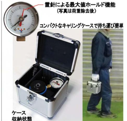
金属屋根・サイディングに施工した各種ファスナー・ビス類の強度確認にもご使用いただけます!
