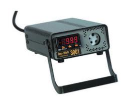
電源に接続し、フロントパネルのスイッチを On して 約 5 分後に指定した温度が ±0.5℃で安定します。そ して、温度計のセンサーをセンサーと同じサイズの穴 に挿入して、DW-3001 の表示温度と温度計の表示温 度の誤差を判定します。DW-3001 は分解能 0.1℃で +33℃~+300℃の間で校正を行うことができます。
