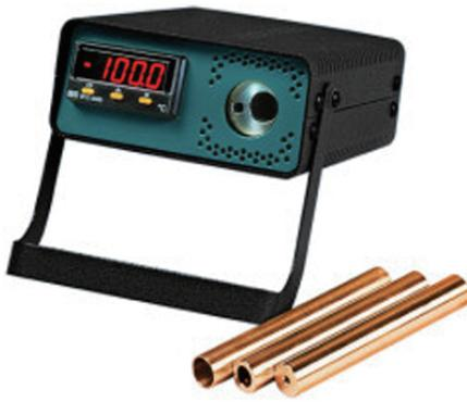
電源に接続し、フロントパネルのスイッチを On して約 5 分後に指定した温度が  $\pm 0.5^{\circ}\text{C}$  で安定します。そして、温度計のセンサーをセンサーと同じサイズのインサートの穴に挿入して、DW-3004 の表示温度と温度計の表示温度の誤差を判定します。DW-3004 ではインサートを交換して、センサー口径 3.3、4.1、4.8、6.4、9.6mm の温度センサーに対応させることができます。
