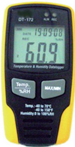
測定したデータは DT-172 とパソコンを付属の USB ケーブルで接続し、短時間でダウンロードできます。測定した温度・湿度データは専用ソフト形式と Excel ファイル形式で自動保存します。
