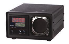
BX-500 を電源に接続し、スイッチを On し希望する 校正温度に設定します。温度が安定した後、赤外線放 射温度計の放射率を 0.95 にし、黒色大型ボディのター ゲットに向け温度を測定します。そして、表示温度と 温度計の表示温度の誤差を判定します。本器には温度 コントロール用の RTD( 白金抵抗体 ) 温度センサー取 り付けております。
