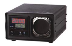
BX-350 を電源に接続し、スイッチを On し希望する校正温度に設定します。温度が安定した後、赤外線放射温度計の放射率を 0.95 にし、黒色大型ボディのターゲットに向け温度を測定します。そして、表示温度と温度計の表示温度の誤差を判定します。本器には温度コントロール用の RTD( 白金抵抗体 ) 温度センサー取り付けております。
