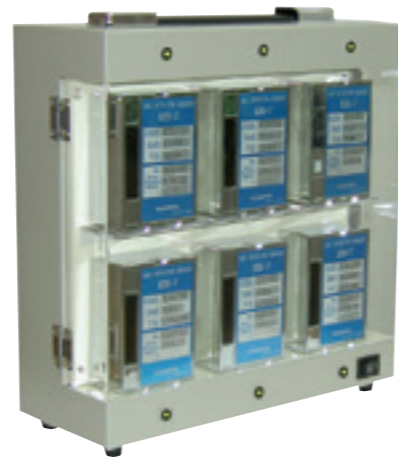
◎センサユニットは専用通電台(EC-7)で通電してください。
