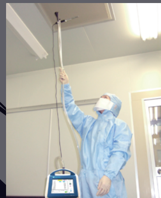
当社クリモマスター風速計用 プローブを使った環境計測風景
