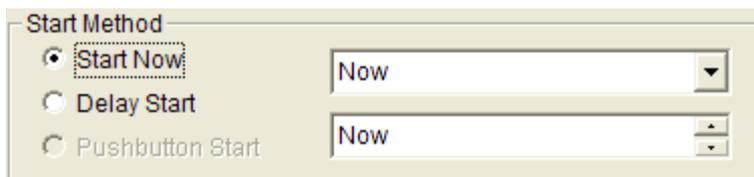
すぐに測定を開始する場合は Start Now にマークをします。指定した日時で測定を開始する場合は Delay Start にマークをします。開始日時を記入するか ▼▲ボタンを押して日付と時間を指定します。
