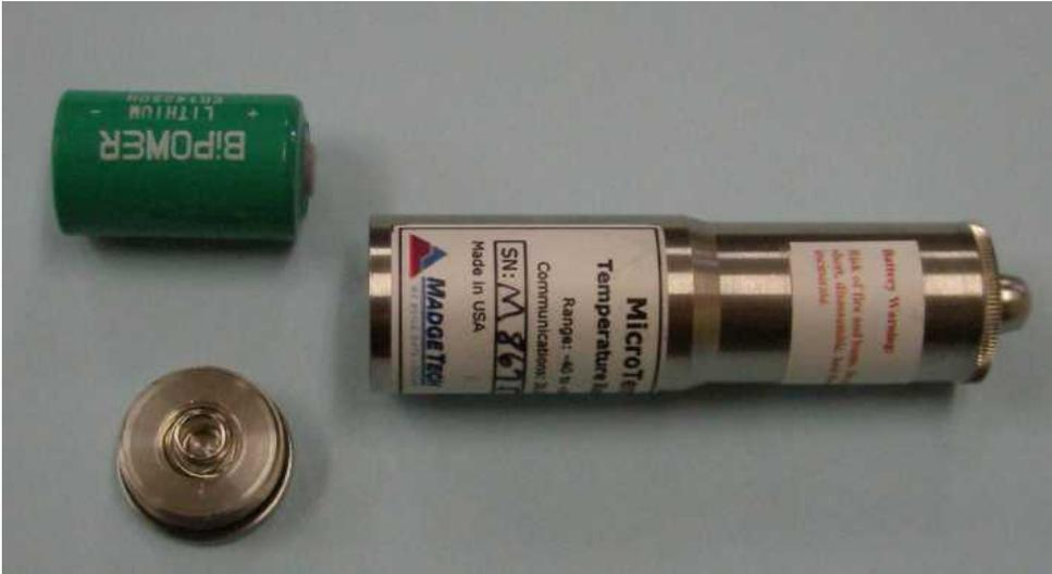
中の電池を取り出し新しいものと交換します。そしてネジをしっかりと固定します。電池を取り付ける + と - 方向を間違えてはいけません。
