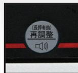
簡単に再調整・精度確認が可能。又、追い込み式ブザー音で画面を見なくても水平・垂直の計測が可能です。
