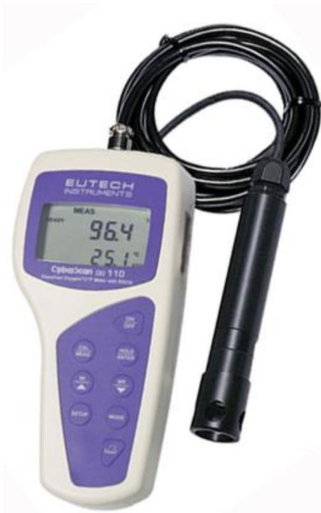
DO 110 は、検査水の溶存酸素、飽和度と温度を測定できる低価格な溶存酸素計です。塩分並びに気圧補正機能付で、正確な溶存酸素濃度を測定できます。DO 電極は 3m コード長付きの投げ込み浸漬対応です。
