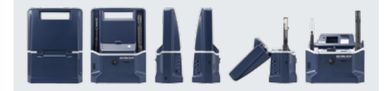
左上：測定ワゴンを折りたたみバッグを肩掛けて楽に移動。右上：校正や修理依頼時には本体から簡単に粉じん計を取り外すことが可能。右中央：キャリングバッグに測定器本体を収納したまま本体を開き測定が可能。下：多角度から見る商品写真。
